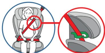
Nur eine korrekte Befestigung BEIDER KLEMMEN gewährleistet den vorgesehenen Halt des Sitzes und die Sicherung Ihres Kindes im Fahrzeug!!!
