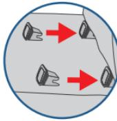
Untersuchen Sie die ISOFIX-Führungen regelmäßig auf Verschmutzungen und reinigen Sie sie bei Bedarf. Die Zuverlässigkeit des Systems kann durch Eindringen von Schmutz, Staub, Lebensmittelresten usw. beeinträchtigt werden.
