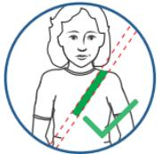
Kindes ein. Überprüfen Sie den Gurtverlauf vor Antritt jeder Fahrt und passen die Kopfstütze der Rückenlehne der neuen Größe des Kindes an. Achten Sie darauf, dass Sie den Beckengurt (O) auf beiden Seiten unter den Haltenasen (C) durchführen, den Diagonalgurt (N) aber nur auf der Seite, die zum Gurtschloss (Q) führt.
