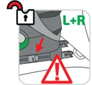
Nur eine korrekte Befestigung **BEIDER KLEMMEN** gewährleistet den vorgesehenen Halt des Sitzes und die Sicherung Ihres Kindes im Fahrzeug!!!
