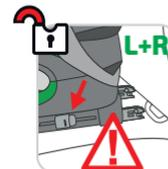
Seulement une fixation correcte LES DEUX CLAMPES garanties le support prévu du siège et la fixation de votre enfant dans le véhicule !
