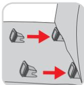
Les points de fixation ISOFIX sont situés entre le siège et le dossier du siège auto.
