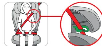
Guidez maintenant la ceinture abdominale (W) avec la languette de verrouillage (V) par-dessus des accoudoirs du rehausseur au boucle de ceinture à trois points et faites encliqueter avec un „CLICK „ audible la languette de verrouillage de la ceinture à trois points du véhicule dans le boucle de ceinture à trois points.
