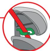
Guíe ahora el cinturón de cadera (W) con la lengüeta de la hebilla (V) por debajo de los reposabrazos del asiento infantil hasta la hebilla del cinturón de tres puntos y enganche la lengüeta de la hebilla (V) del cinturón de tres puntos del vehículo en la hebilla del cinturón de tres puntos con un <<CLIC>> audible.
