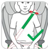
La courroie diagonale doit passer par-dessus l'épaule au milieu, la courroie sous-abdominale doit passer aussi bas que possible sur l'aîne.
